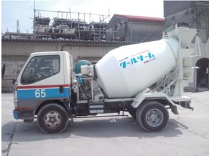
生コンミキサー車 施工年月:2013年6月 台数:8台 タンク内の温度上昇を制御し、生コンクリートの凝固反応が促進されるのを軽減。
